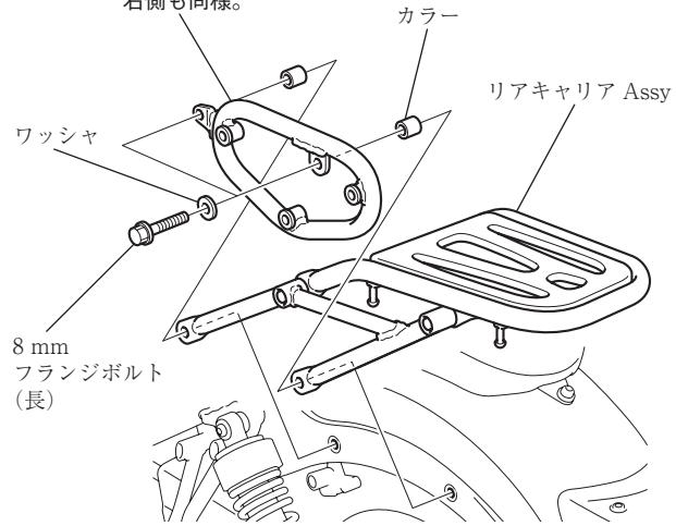
3) 図のように仮付けした部品を締め付ける。
