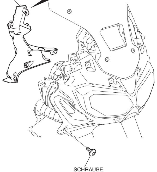
15. Entfernen Sie die Schraube, wie in der Abbildung dargestellt.
